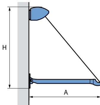
Je größer der Ausfall, desto effektiver ist die Fallarmmarkise. Für den Ausfall sind nur Standardgrößen möglich. Das sind: 50, 60, 70, 80, 90 oder 100 cm
