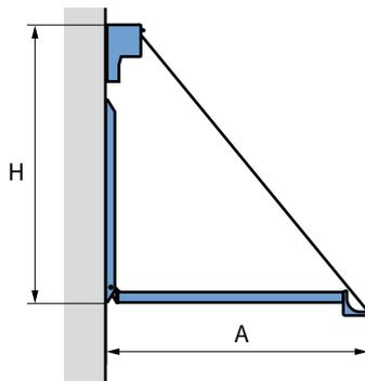
Je größer der Ausfall, desto effektiver ist die Fallarmmarkise. Für den Ausfall sind nur Standardgrößen möglich. Das sind: 100, 115, 135 oder 150 cm
