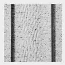
Waffelbildung oder Faltenbildung Alle technischen Gewebe können diese Waffelbildung in der Mitte des Tuches aufweisen. Sie sind vor allem bei Gegenlicht durch den unterschiedlichen Lichteinfall sichtbar.
