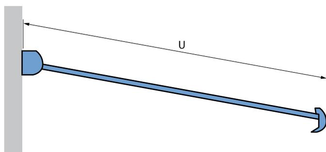
Die Auslage ist der maximale Abstand zwischen der Wand und der Vorderleiste. Je größer die Auslage, desto mehr Effekt hat die Markise.
