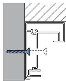
Abb. 1.3 Montage der hinteren Führung
