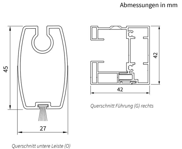
maximale Bestellhöhe V540 = 3000 mm
