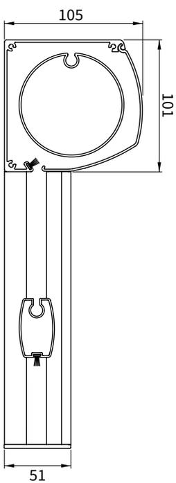
Querschnitt Kappe (K), untere Leiste (O) und Führung (G)
