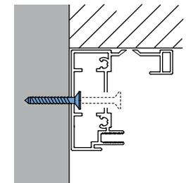
Abb. 1.4 Montage hintere Führung Ritzscreen® V540/V599 L
