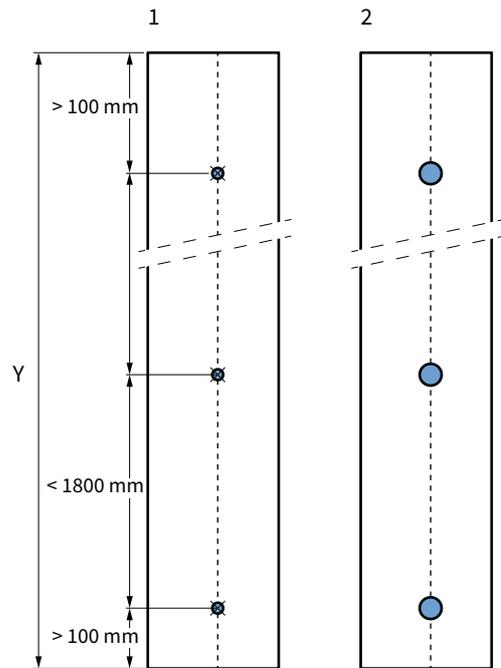
Abb. 1.2 Bohren der Montagelöcher
