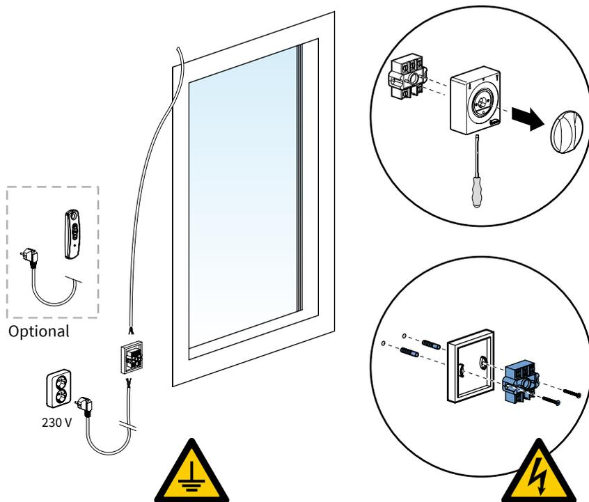
3. Öffnen Sie den Schalter mithilfe eines Flachkopfschraubendrehers.
