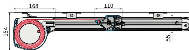
Abb. 3 Querschnitt Veranda-Sonnenschutz
