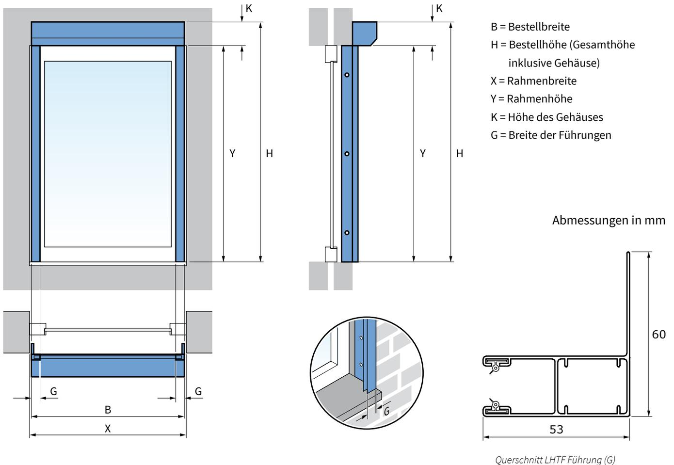
Bei dieser Montage wird das Gehäuse auf der Wand über dem Rahmen montiert.
