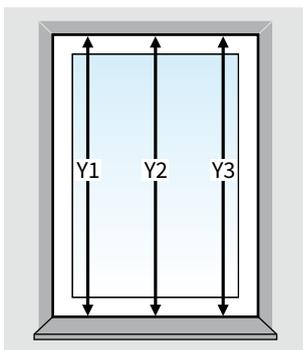
Messen Sie das Höhenmaß (Y) von der Oberkante der Wand bis zur Fensterbank in mm.
