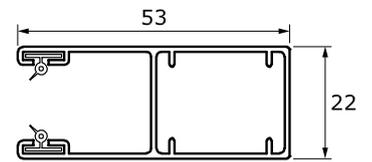
Querschnitt HTF Führung (G)
