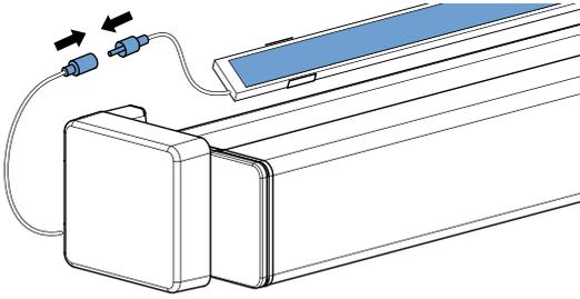
fig. 5.3 Anschluss des Solarpanels
