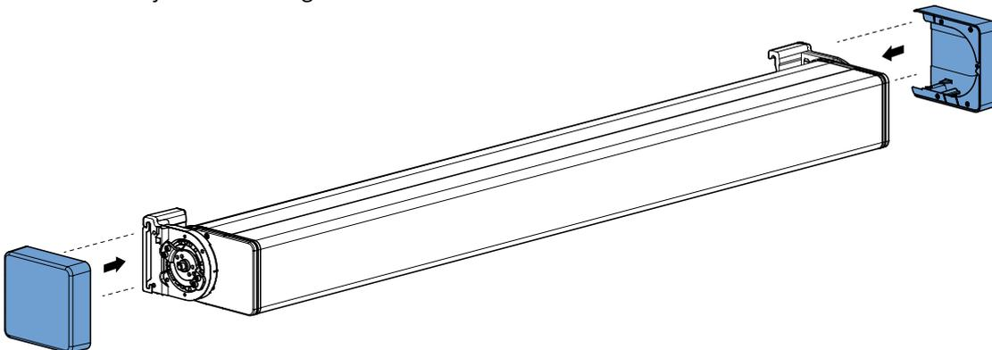
Abb. 7.1 Montage des Seitenschutzes
