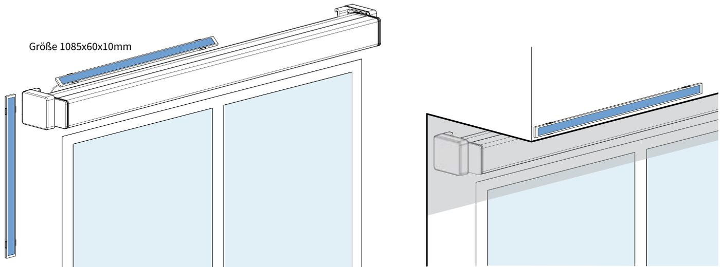
fig. 5.1 Positionierung des Solarpanels
