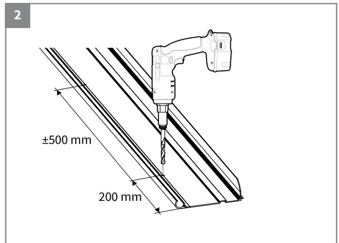
Bohren Sie Löcher in das Wandprofil (1). Abstand zwischen Löcher etwa 50 cm.
