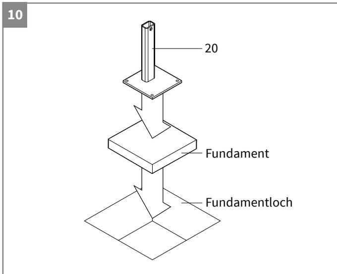
Fußplatte (20) und Fundament platzieren (2x)
