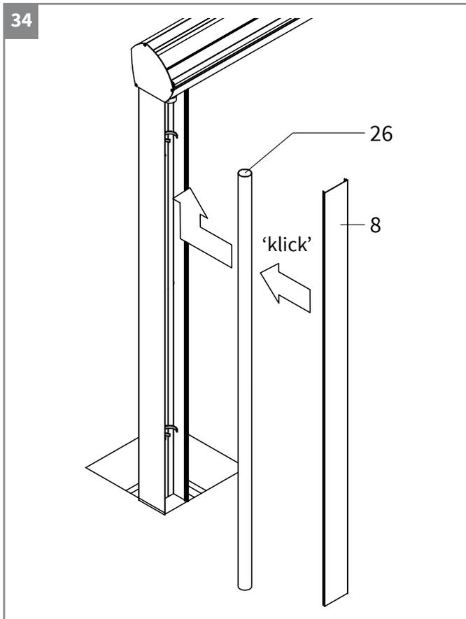
Wasserabfluss befindet sich in der Innenseite des Pfostenn.
