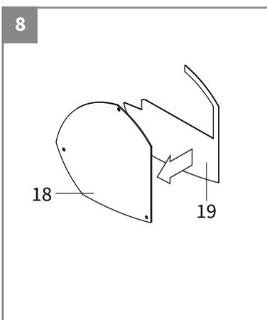
Kleben Sie den EPDM-Schaum auf die Innenseite der Seitenplatten des Rinnenprofils (Abbildung 8).
