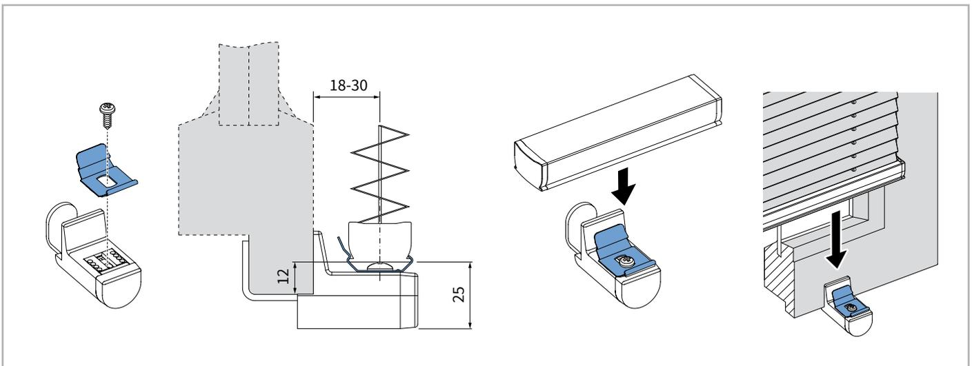
Montage spanvoetje op beugel draai/kiepraam
