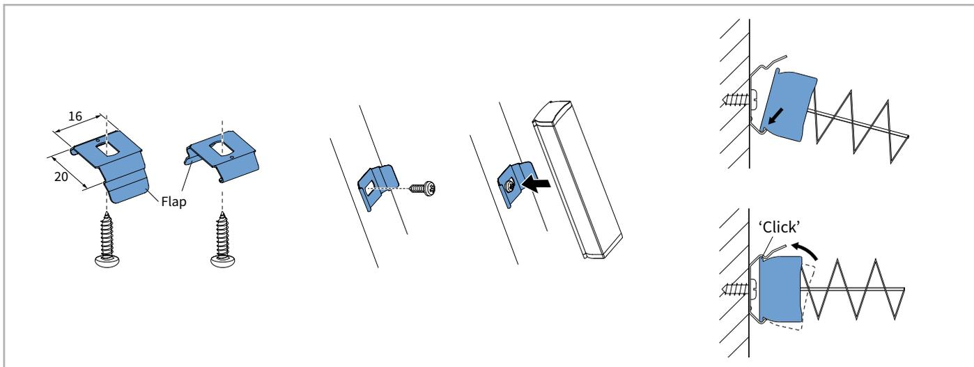
**Montage met clip 27 mm (motor profiel)**
