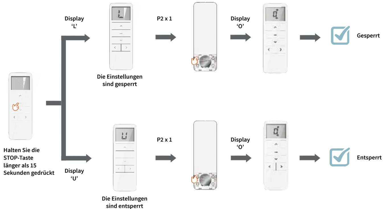
**Achtung!** Mit der Sperrfunktion können Sie keine Funktionen programmieren, für die Sie zwei Tasten wie Grenzwerteinstellungen und Richtungswechsel benötigen.
